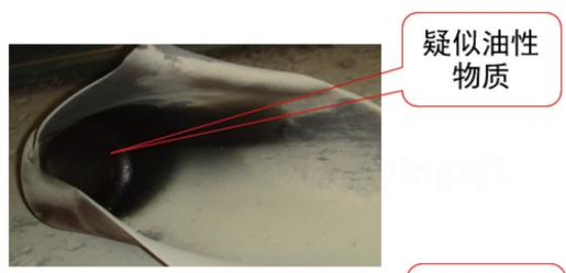
(2) 该氧气瓶出厂标定为氮气瓶，但氧气生产厂违反国家质监局颁发【2000】250号《气瓶安全监察规程》中严禁气瓶混用规定，擅自改充氧气，并涂改为天蓝色。(氮气瓶为黑色，氧气瓶为天蓝色)
