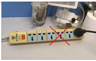
万能插座有较大安全隐患，应使用符合国家标准的插线板
